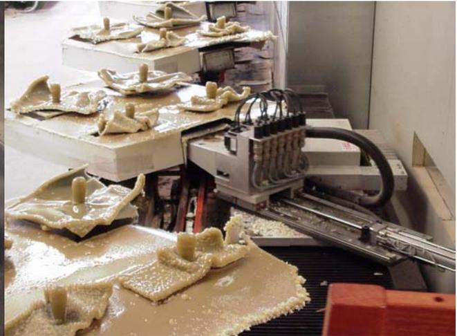
Il sistema è composto da due robot Irìde ad inseguimento per catena opportunamente posizionati per operare in sincrono. Per fare funzionare il sistema è necessaria una area di lavoro come quella disegnata in figura, denominata "isola di lavoro", in cui viene realizzato l'impianto di verniciatura. All'interno dell'impianto si posiziona un binario che segue un percorso predefinito e sono individuate le seguenti zone:
